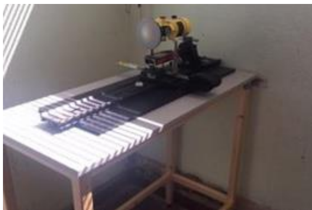
Distancemètre de référence et banc d'étalonnage en longueur des transducteurs radar
