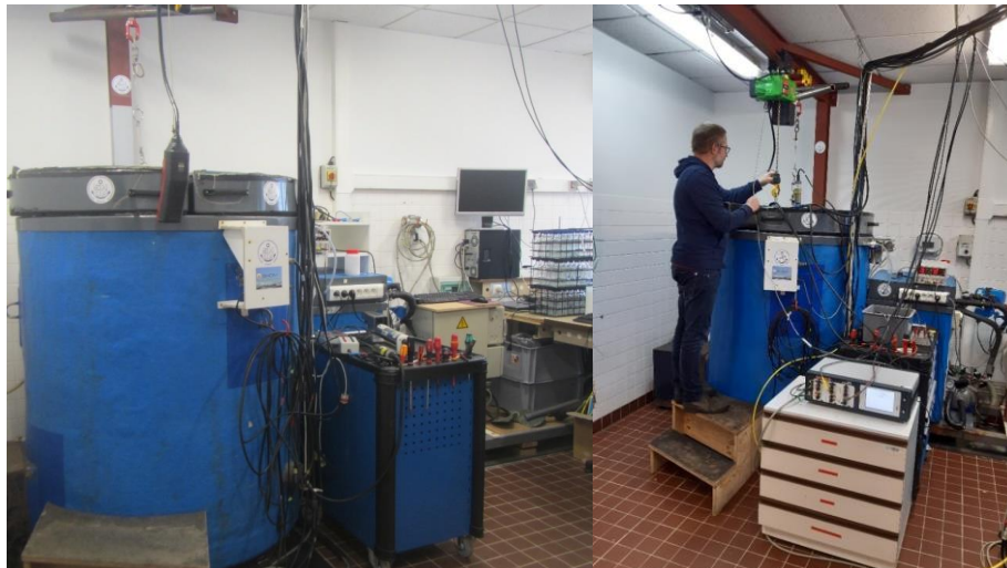
Bain de 800 l, son système de régulation et son PC de pilotage. Le palan et le chemin de câbles suspendu permettent de relier les instruments situés dans la cuve à la baie ou au PC d'acquisition
