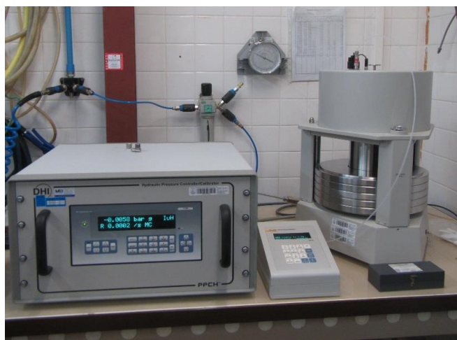
Balance de pression automatique alimentée en air comprimé
