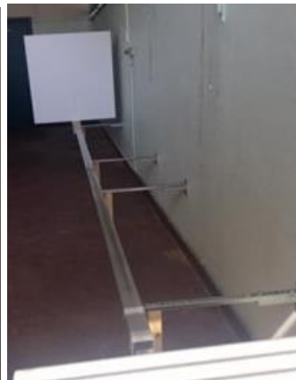
Distancemètre de référence et banc d'étalonnage en longueur des transducteurs radar
