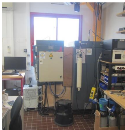
Bain de 200 l avec son système de régulation et son PC de pilotage
